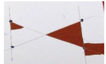
HSPA -1 EPOXY PRIMER + POLYCARBAMIDE TOPCOAT Crosshatch adhesion
