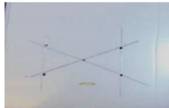
ANCAMIDE® 2832 EPOXY PRIMER + POLYCARBAMIDE TOPCOAT Crosshatch adhesion
